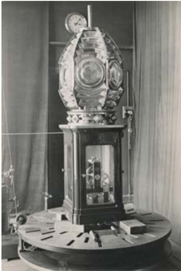
De optiek van 1876 met valuurwerk, opgesteld bij de Technische Dienst van 's-Rijkskustverlichting in Scheveningen.
