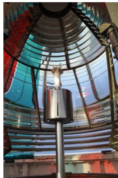
De vastlichtoptiek met lampenwisselaar in 2012. De groene en rode sectoren zijn in 2015 verwijderd.
