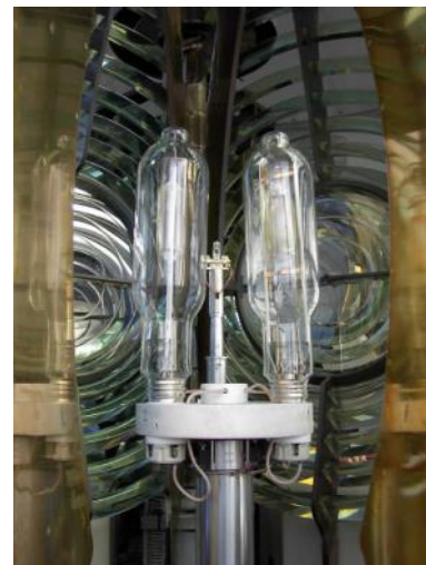
Lampenwisselaar met kwikjodidelampen.
