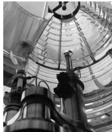
De oorspronkelijke lampenwisselaar uit 1923, met gloeilamp en gasgloeilicht.
