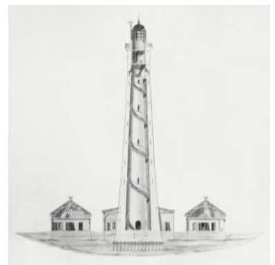
Tekening van de vuurtoren op Schouwen uit 1840. De toren bestaat uit twee cilinders, met daartussen een wenteltrap.
