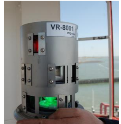
Het in 2013 geplaatste led-armatuur met witte, rode en groene sectoren.
