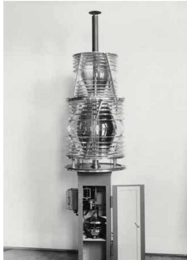
De optiek van de vuurtoren van Den Oever uit 1948.
