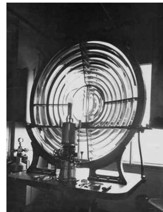
De optiek van de Kleine Kaap, met een pharolinegloeilicht.
