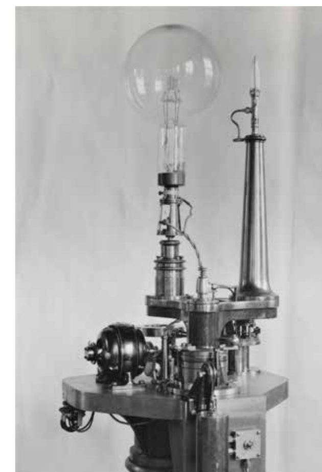
Lampenwisselaar uit 1923 met Brandarislamp en gasgloeilicht.
