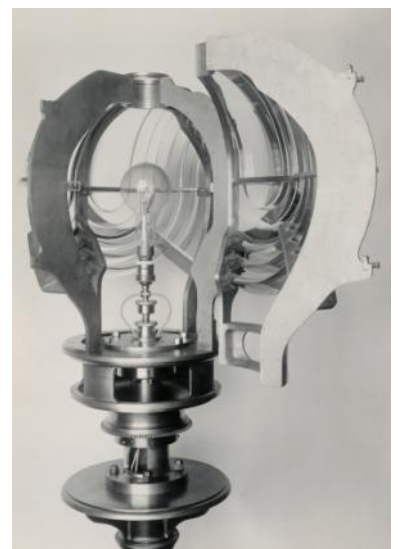
In 1922 kreeg de vuurtoren een nieuwe scheepvaartoptiek, een luchtvaartoptiek en een glazen koepel met een extra omloop.
