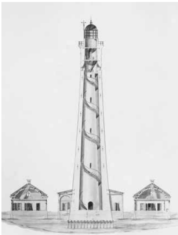
De vuurtoren van West-Schouwen en twee lichtwachterswoningen in 1840, dwarsdoorsnede en vooraanzicht.
