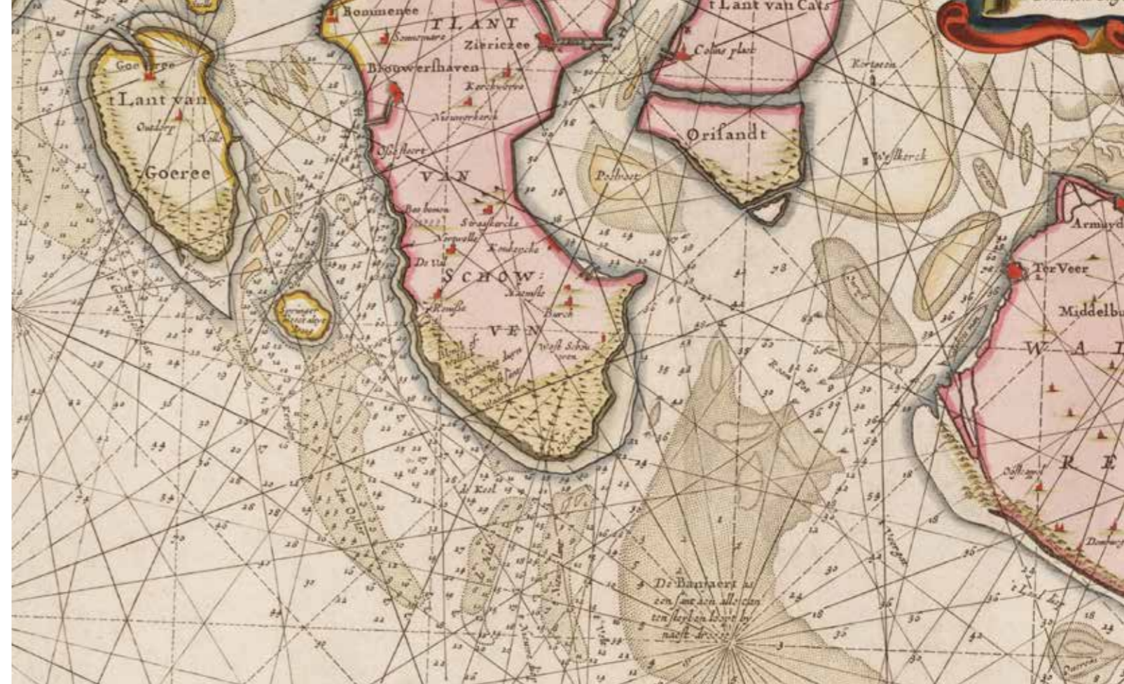
Fragment van een paskaart van Zeeland uit 1666, van Pieter Goos. Twee kappen in de duinen van Schouwen vormen een zichtlijn langs de stuurboordzijde van zandbank 'de Hille'. Twee vuurboeten vormen een lichtenlijn langs de bakboordzijde van zandbank 'Nieuwe Lant'. Beide geleidelijnen geven de veilige route aan naar de Scheldemond en Zierikzee.
