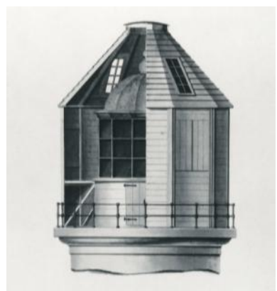
De houten kap die de lantaarn tijdens de opbouw moest beschermen.
