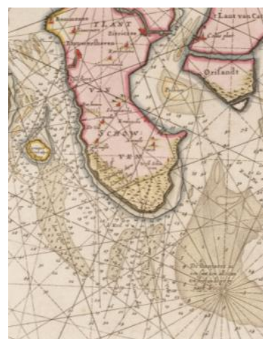
Fragment van een paskaart uit 1666 met daarop de zichtlijn van twee kappen en de lichtenlijn van twee vuurboeten.
