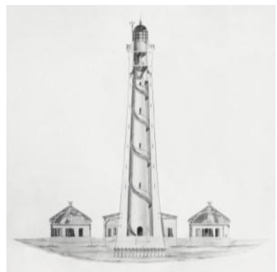
De vuurtoren van West-Schouwen in 1840. De toren bestaat uit twee cilinders, met daartussen een wenteltrap.
