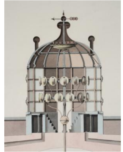
De lantaarn en het lichttoestel met Argandse lampen uit 1817.
