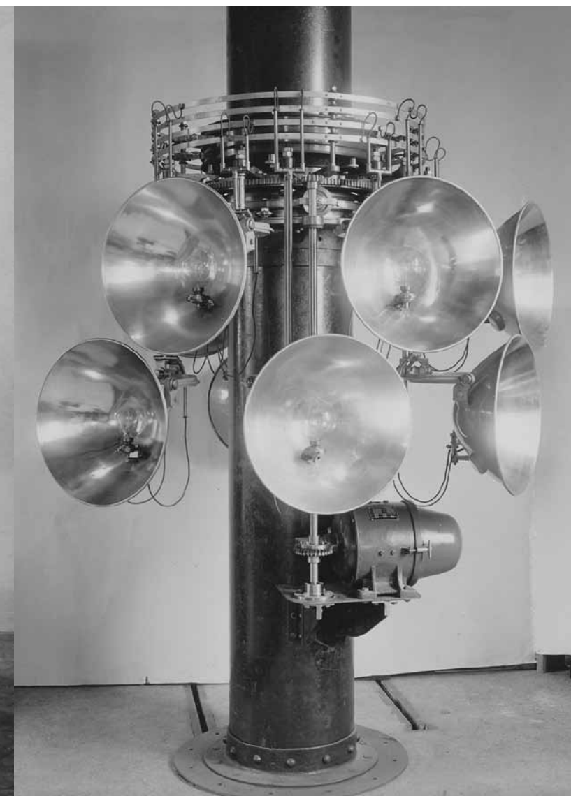
Lichttoestel voor een lichtschip uit de jaren twintig, met parabolische reflectoren en halfwattgloeilampen.
