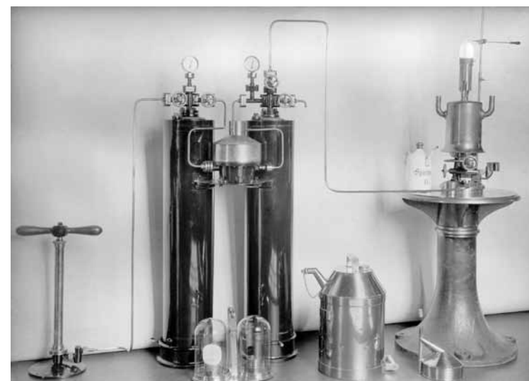
Pharolinegloeilicht met toebehoren, opgesteld in het proefstation
