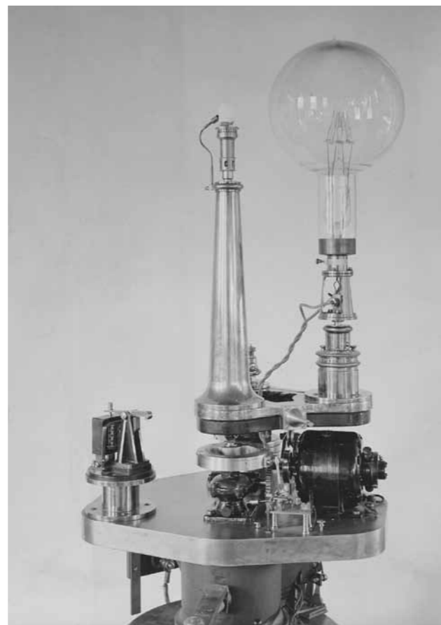
In 1922 construeerde het proefstation in Scheveningen een lampverwisselaar met Brandarislamp en Blaugasgloeilicht.
